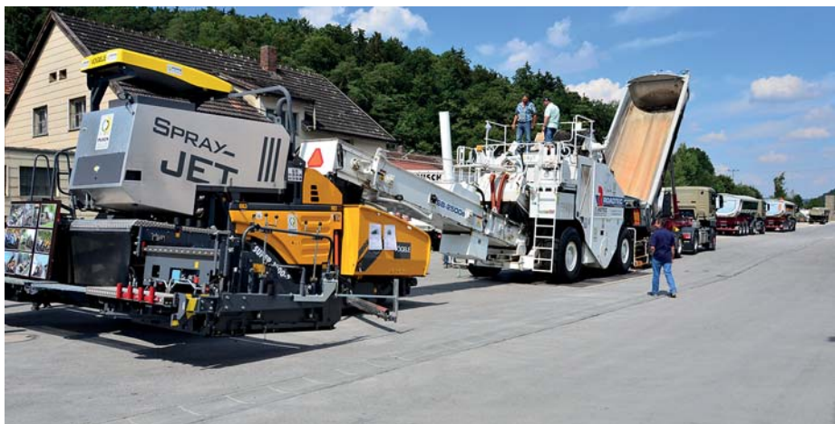
Der Sprühfertiger Vögele Super 1800-2 mit Spray-Jet-Modul besitzt eine integrierte Sprühvorrichtung für Bitumenemulsionen. (Fotos: VDBUM)
