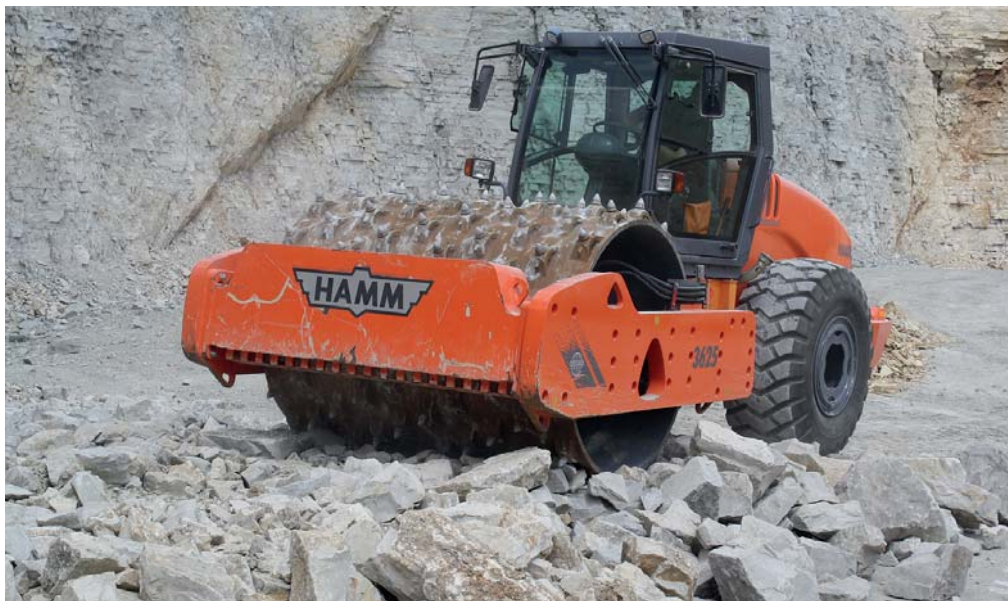
Die neue Hamm-Walze mit Felsbrecherbandage zerkleinert und verdichtet Baustoffe.
